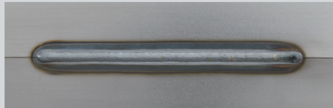
두께 0.8mm, 용접전류 40A, 용접전압 16V, 와이어경 0.6mm, 용접속도 45cm/min
